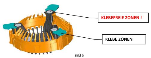
Nach dem Auftragen des Klebers, Roofguard nehmen und zentrisch über dem Dachgully (60-200mm) durch aufdrücken verkleben (Bild 6)
