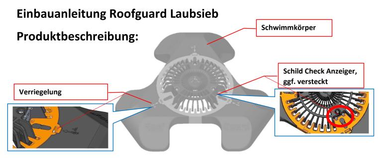
Das Laubsieb wird an den Klebeflächen, die unterhalb der Füße angeordnet sind, mittels beigelegtem Kleber (ausgenommen der markierten Fläche) über dem Gullyabfluss mit einem Durchmesser > 60 < 200 mm, zentrisch verklebt. Um eine Verklebung der Schwimmkörper mit der Abdichtung zu verhindern, muss am Dachgully im Durchmesser von 60cm ein ebenmäßiger Untergrund vorhanden sein.
